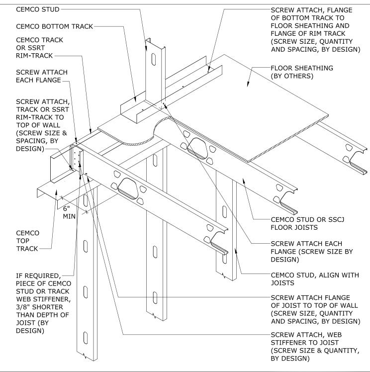
**EXTERIOR WALL - JOIST PERPENDICULAR TO WALL**
